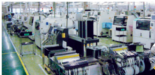
電子基板を生産する実装ライン（鉛フリー）
